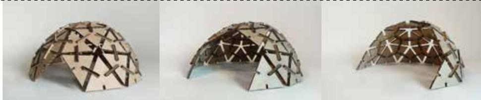
**Slike 5-7:** Prototip zaprte kupole, delno odprte kupole in odprte kupole
